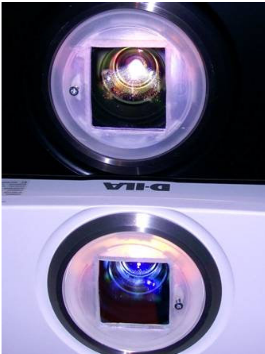
Übereinandergestellte Projektoren (2 x DLA-X35B/W) mit entsprechenden farbcodierten Glasfilter, integriert in die Objektivabdeckung.
