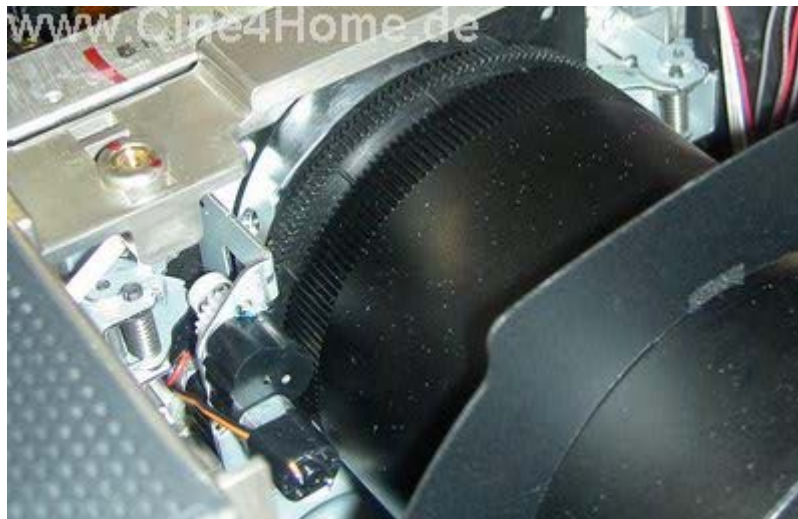
Die hochwertige Optik-Mechanik mit Antriebsmotoren
