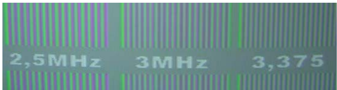
Analoge Zuspiegelung, Dynamikverlust in hohen Auflösungsbereichen
