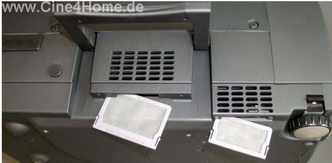
Die Ansaugstutzen mit Feinfilter
