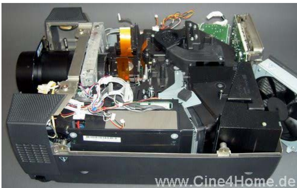
Der Lichtweg durchläuft das gesamte Gerät
