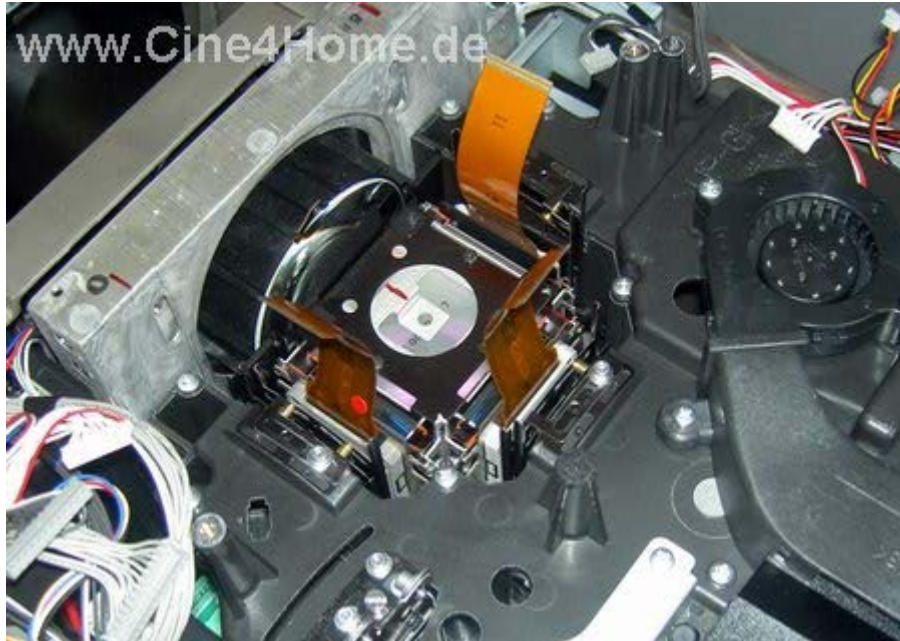
Der große optische Block mit Belüftungskanälen
