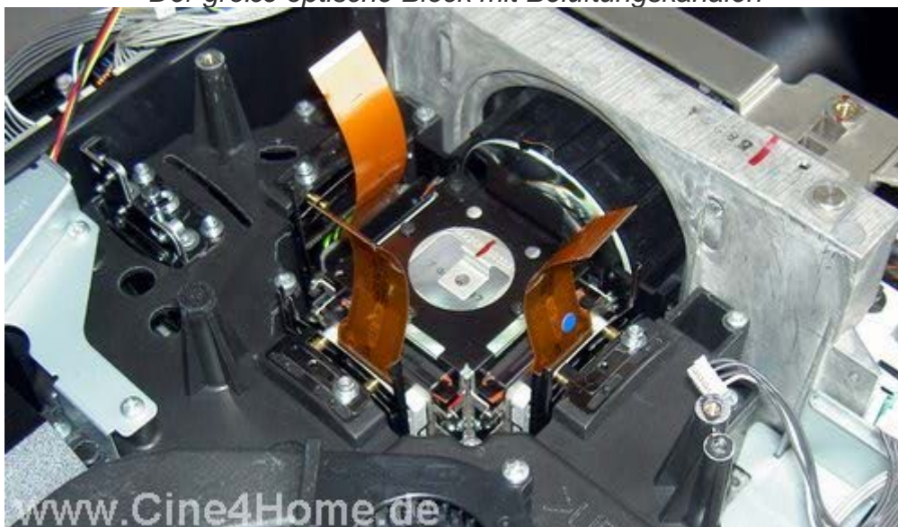
Der große optische Block mit Belüftungskanälen
