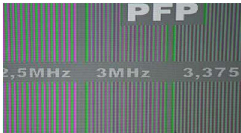
Ähnlich gut sieht es bei der Farbauflösung aus. Auch hier sorgt eine gute Skalierung für eine angemessene Auflösungsanpassung ohne störende Artefakte. Die Farbtrennung ist bis zur höchsten Auflösung gewährleistet, könnte aber stellenweise noch präziser ausfallen.
