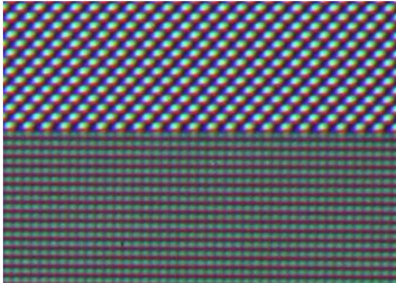
Etwas mehr Toleranzen werden hingegen bei der Konvergenz zugelassen, bei den von uns gesichteten Testgeräten zeigte meist Rot einen Versatz von einem 3/4-Pixel. Obiger Screenshot zeigt pixelgenau weiße Punkte, bei denen die Konvergenz besonders gut erkennbar ist.
