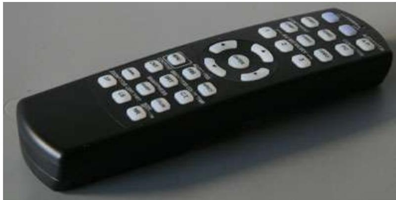
Die direkten Quellen- und Formattasten sowie das großzügige Steuerkreuz fallen positiv auf. Die Reichweite des Infrarotsenders ist dabei ausreichend, auch für größere Räume. Auf der Geräteoberseite befinden sich zudem alle wesentliche Funktionstasten, versteckt unter einer Abdeckklappe.
